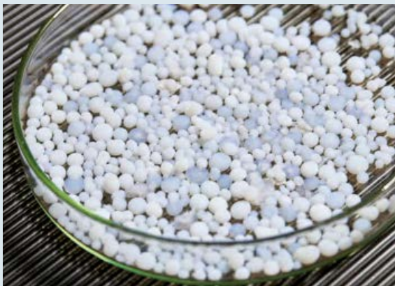
Kleine Köner: Das Aerogel wird in den Dämmputz integriert.
