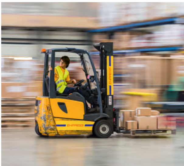
Gabelstapler fahren sechs bis sieben Kilometer pro Stunde und wiegen ohne Ladung teilweise über 500 Kilogramm.
